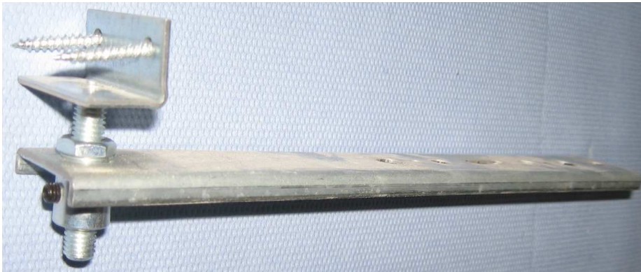
Bild 2 WU-Anker mit Führungshülse, Gewinde M8 mit Winkelblech und Stellmutter zur Höhenjustage
