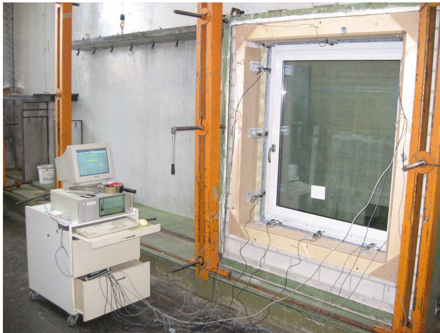
Bild 9 Ansicht Probekörper mit angebrachten Messstellen
