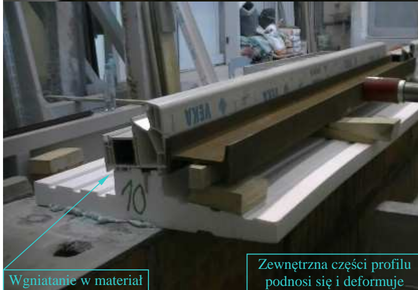
Próbka w początkowej fazie obciążenia siłą, obrót ramy i wrywanie z zewnętrznego zaczepu profilu.
