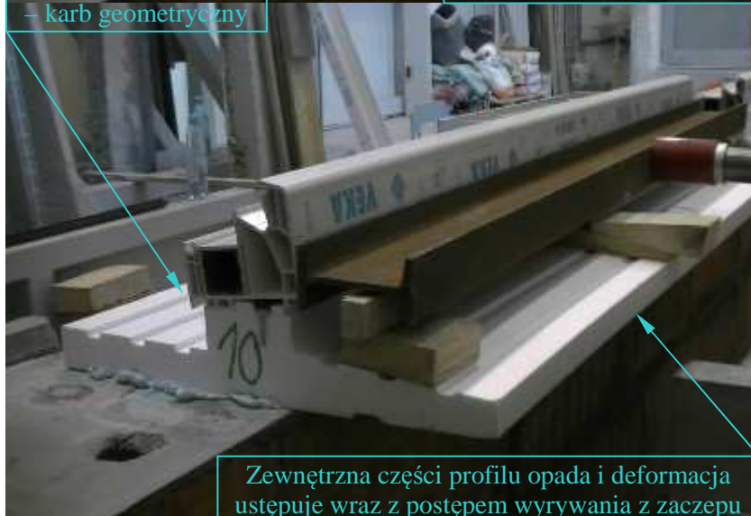
Próbka w początkowej fazie obciążenia siłą, kontynuacja obrotu ramy i wrywanie z zewnętrznego zaczepu profilu.
